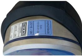
**Abb. 3 - CPG1200 mit Gehäuseschutzkappe**
